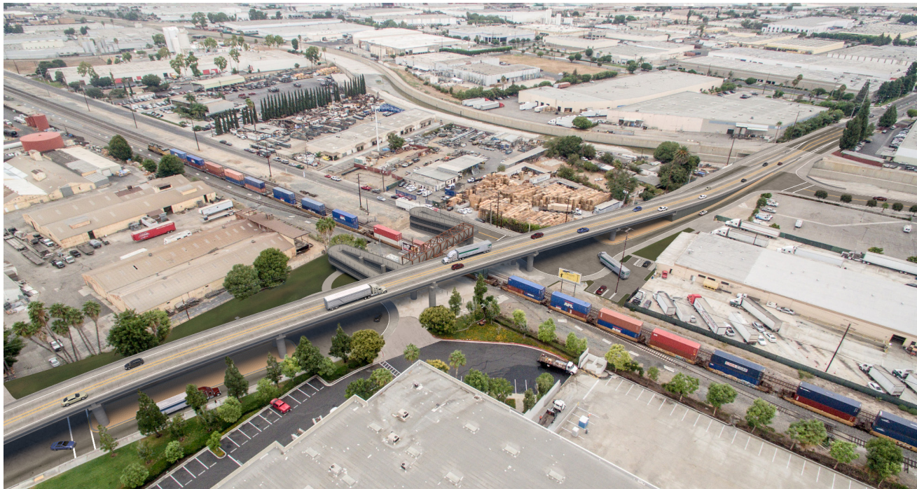
Representación aérea de la separación a nivel de Turnbull Canyon Road completada.
